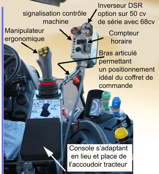
Vue d'ensemble de l'option commandes proportionnelles électro hydraulique basse pression.
