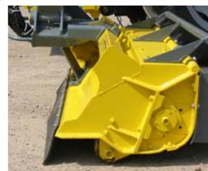
Détail rotor avec rouleau « TIM » et barre « protégé poteau électrique » + de série machine équipée de 2 panneaux fauchage et son support panneau.
